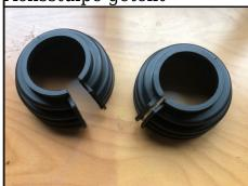
Achsstulpe geteilt als Reparatur Tausch ohne Achskörper zu demontieren für 710, 712, 716, 718 Modelle
